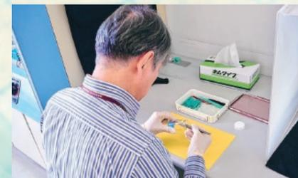
ガラス瓶の底に作製したイオンゲルをピンセットで取り出す
