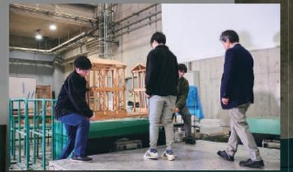
3年生の授業では3次元振動台に家屋の模型を載せて実験を行う。左右・前後に加え上下にも振動して実際の地震の動きを再現することができる。ここでは筋交いのあるなしを比較している。
