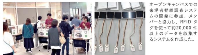
オープンキャンパスでの来場者動線調査システムの開発に参加。メンバーと協力し、RFIDタグを使って約20,000件以上のデータを収集するシステムを作成した。
